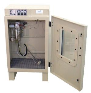
Sistema elettrostatico manuale per vernici a base acqua, con isolamento ed alimentazione a media pressione. Utilizzabile con fluidi ad elevata viscosità, con serbatoio in inox di alimentazione (opzionale). Pompante in inox e passaggi fluido adatti alle vernici base acqua. Sistema elettrostatico innovativo con regolazione della quantità di prodotto, dell'aria e del voltaggio all'esterno dell'armadio. Sistema automatico di lavaggio, (opzionale).
